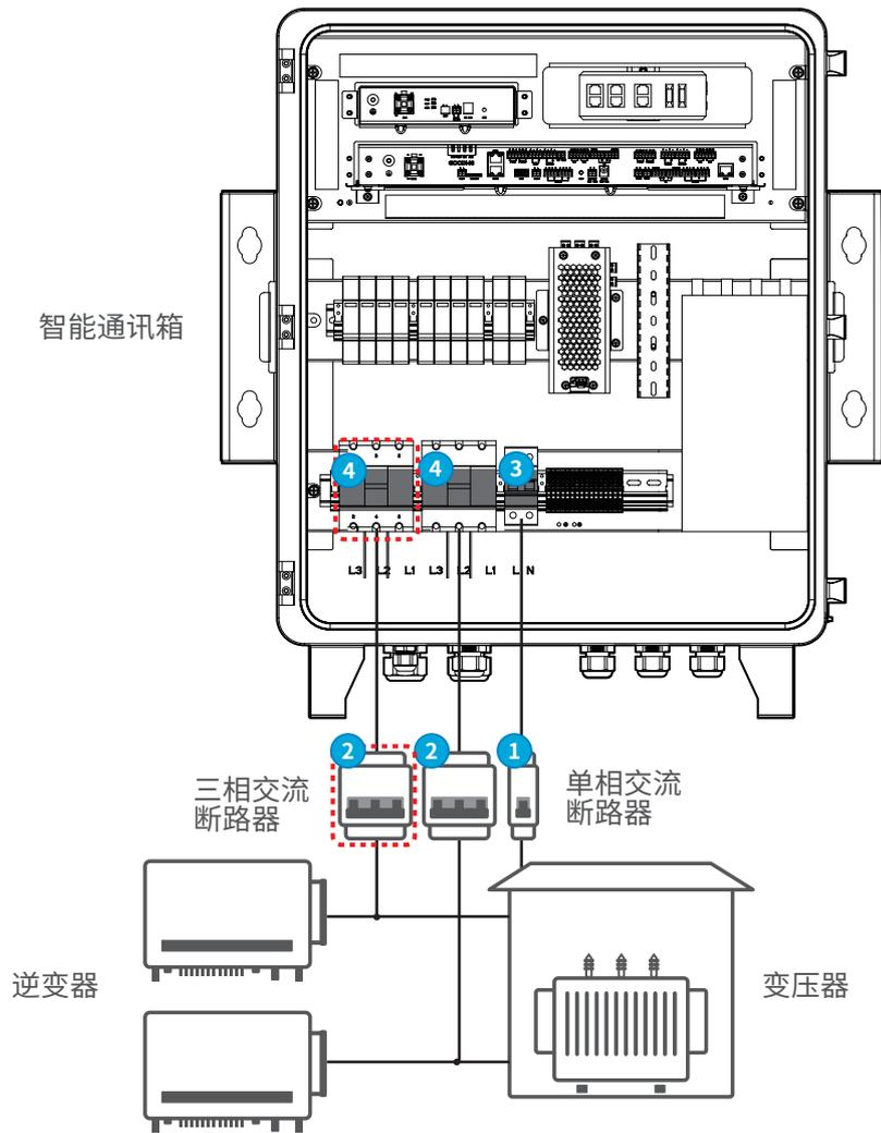
**步骤1:** 闭合远端箱变给智能通讯箱供电的单相电源开关。
