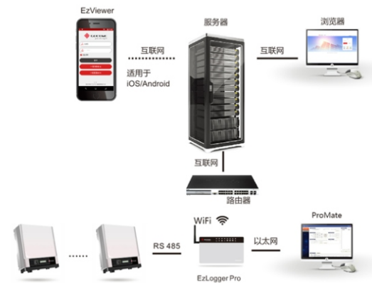
图6.1-1 Wi-Fi版监控系统图
