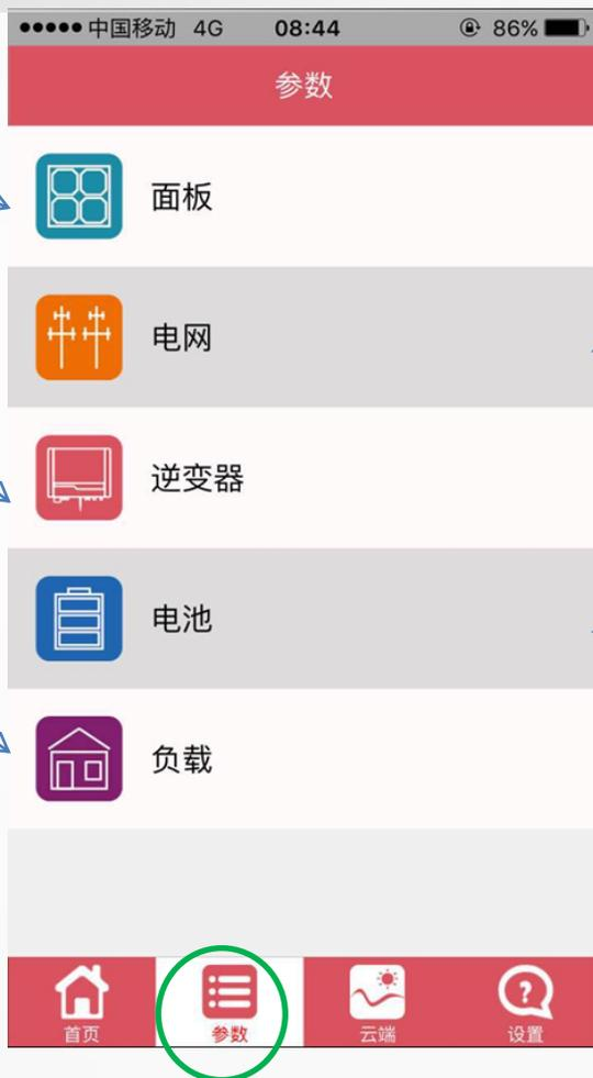
检查AC侧的参数和通信状态：
