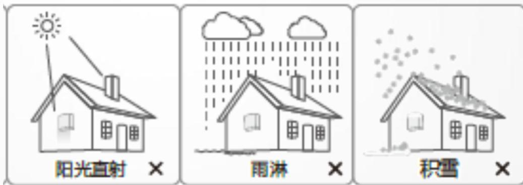
**注释:** 每一个固德威的逆变器都有IP65的防护等级, 安装指导是为了更好的性格和更长的生命周期。
